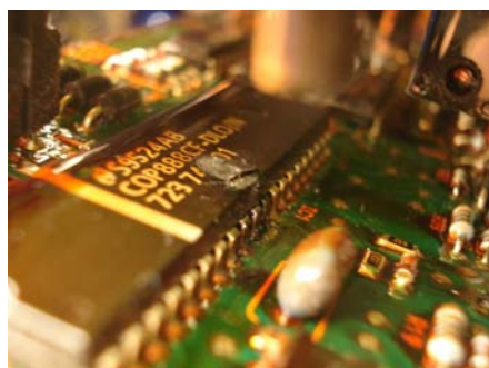
Отгоревшие выводы питания и дыры в процессорах COP888CF.
